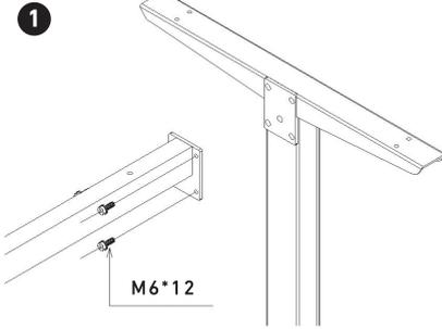
1. Sử dụng 4 ốc M6\*12 ở mỗi bên để lắp ghép thanh đòn trung tâm với 2 chân
